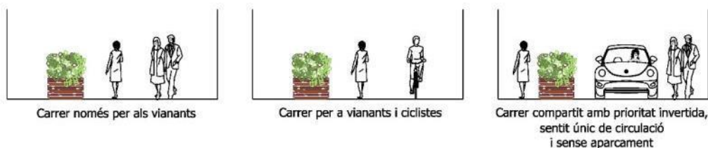
Gràfic 17. Possibles seccions per a carrers amb menys de 7 m d'amplada
