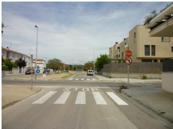
Imatge 55. Aspecte massa continu entre trams, amb gran ample de calçada, que afavoreix velocitats excessives.
