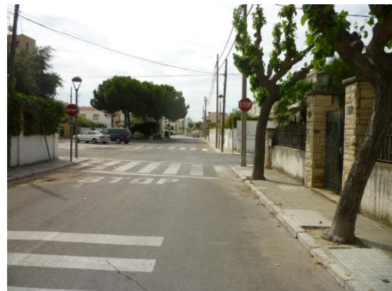
Imatge 42. Cal definir les fileres d'aparcament i establir orelles en la intersecció per millorar la visibilitat.
