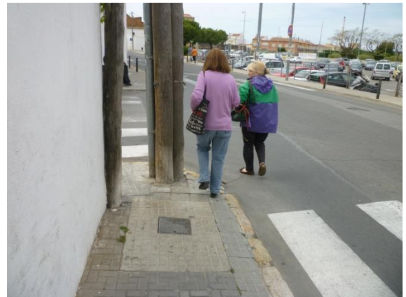
Imatge 16. Carrer Nou. La vorera és molt estreta, fet que junt amb la localització de pals de la llum suposa una completa anulació de la vorera, obligant els vianants a travessar per calçada.
