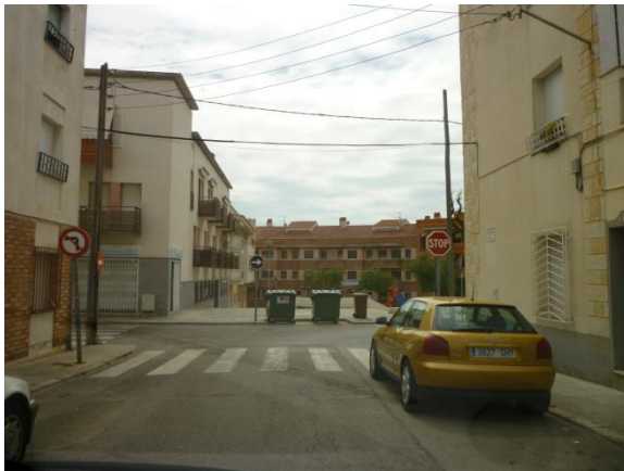
Imatge 3. És freqüent la manca de línia de detenció i senyalització horitzontal de les prioritats.
