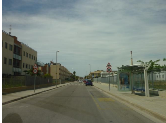
Imatge 80. Trams on es defineix l'espai d'aparcament i parada bus, però és manté un ample de calçada excessiu.
